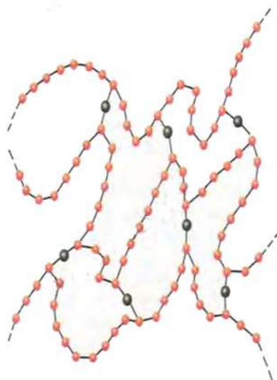
Рис. 34. Схема строения вулканизованного каучука (резины). (Красные кружки обозначают звенья макромолекул каучука, черные — мостики из атомов серы)
