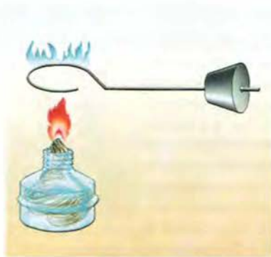
Рис. 111. Качественное определение галогена в органическом соединении
