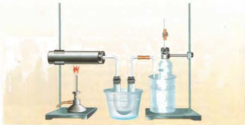
Рис. 55. Коксование каменного угля в лаборатории
