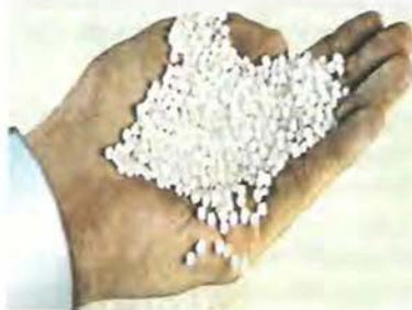
Рис. 104. Полиэтилен в гранулах поступает на перерабатывающие предприятия для изготовления товаров народного потребления
