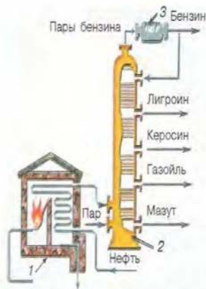
Рис. 48. Схема промышленной установки для непрерывной перегонки нефти: 1 — печь; 2 — ректификационная колонна; 3 — холодильник
