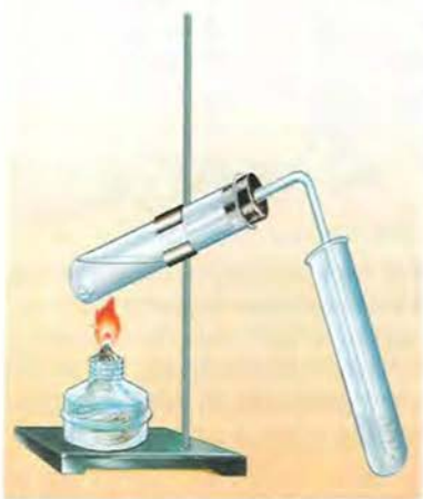
Рис. 112. Получение этилена из этилового спирта
