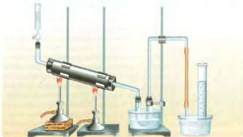
Рис. 52. Крекинг керосина в лаборатории
