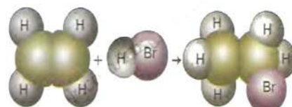
Рис. 28. Модельная схема реакции присоединения бромоводорода к этилену
