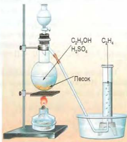
Рис. 30. Получение этилена в лаборатории
