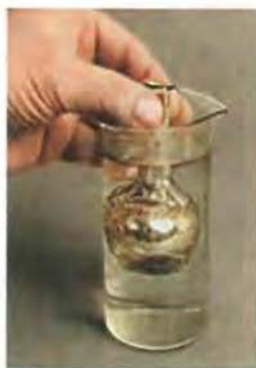
Рис. 70. Взаимодействие альдегида с аммиачным раствором оксида серебра — «реакция серебряного зеркала»
